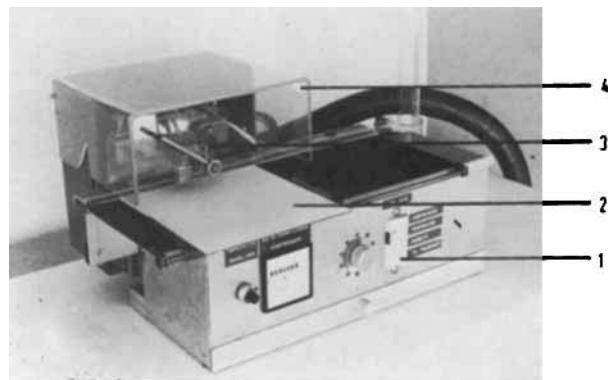
Abb. 4. Mikroautoklav mit DC-Auffangvorrichtung: 1 Steuerschaltungen, 2 Transportschlitten mit DC-Platte, 3 Mikroautoklav mit Absperrventil, 4 Plexiglashaube mit Absaugvorrichtung.
